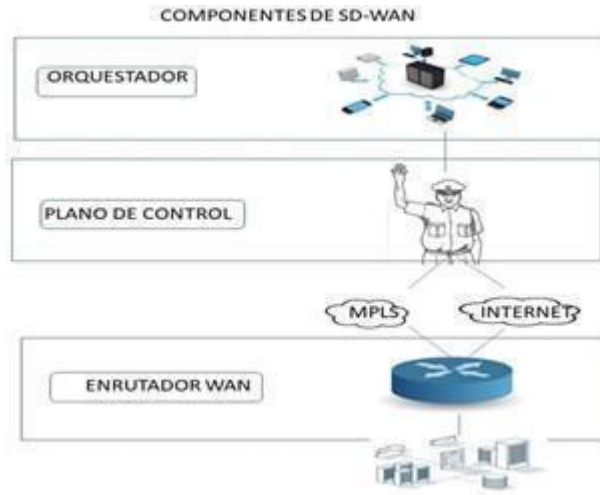
Ilustración 11: Esquema general de los planos de la SD-WAN
