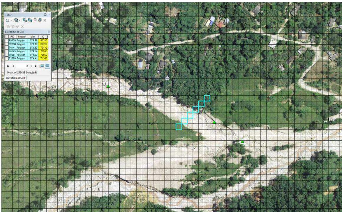
**Figura 59.** Tq2-2, donde se el caudal transitado es de 222 m<sup>3</sup>/s.
