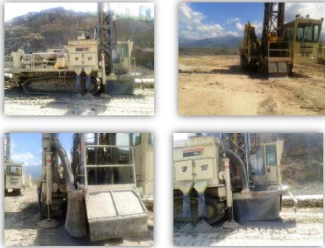
FOTOGRAFÍAS: 26, 27, 28 y 29 FECHA: Enero-Diciembre de 2012 LUGAR: Pit de Minería OBSERVACIONES: Taladros utilizados para las labores de perforación y voladuras, los cuales cuentan con los colectores de polvo, para el control de emisiones.
