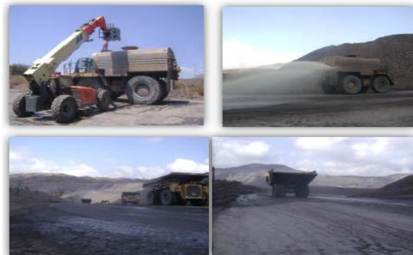
FOTOGRAFÍAS: 10,11,12 y 13 FECHA: Mayo y Junio de 2012 LUGAR: Diferentes tramos y vías de la mina. OBSERVACIONES: Prueba de Supresor de polvo DL10 en las vías internas de la Mina.
